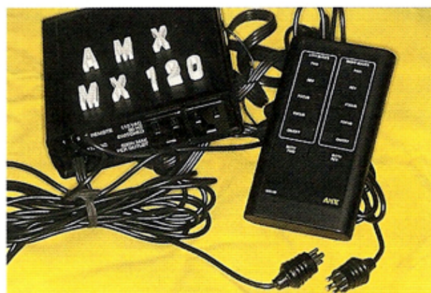
圖四十五：AMX, MX 120雙幻燈機無線遙控器，目前控制雙機幻燈片放映之最佳遙控器。
