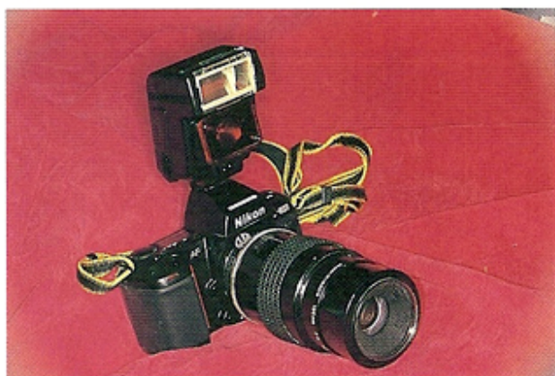
圖九：筆者臨床口外攝影之裝備①Nikon 801相機，採用手動(manual)，速度在1/60秒到1/125秒之間均可；②Nikon 105mm microlens；③Nikon speedlight SB-22，筆者照口外臉部攝影，一律採用TTL，光圈放在f5.6。
