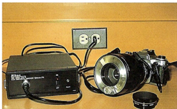
圖十三：Medical Nikkor 120mm lens，具有一接寫鏡頭可放大到實體之兩倍，沒接寫鏡頭時，則可直接照到1:1。本身附有環形閃光燈，只要選好放大倍數，鏡頭上之光圈即自動設定好，使用非常方便，效果亦極佳，缺點是光圈無法調，若曝光效果不佳時，則可利用ASA之調整來代償，因操作方便不必傷腦筋去調光圈，筆者戲稱其為傻瓜鏡頭，傻雖傻，但拍攝之效果卻極佳。
