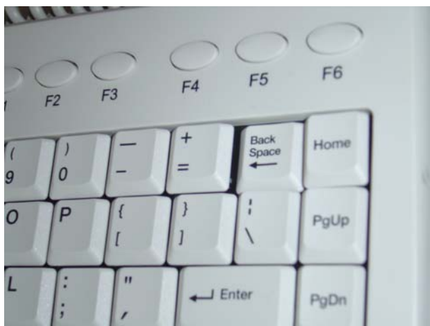
圖 5. 鍵盤右上角 “Back Space” 按鍵陷落
