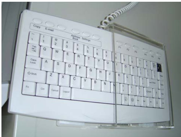
圖 5. 鍵盤右上角 “Back Space” 按鍵陷落
