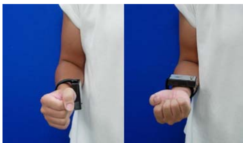
Figure 4 以磁阻感應元件量測肘關節外旋之活動度。左圖為復健初始動作，右圖為外旋之動作。
