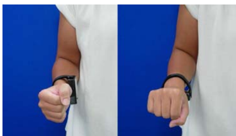
Figure 3 以磁阻感應元件量測肘關節內旋之活動度。左圖為復健初始動作，右圖為內旋之動作。
